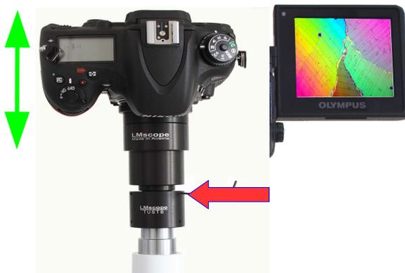
Sollte in der Grundeinstellung das Bild am Kameradisplay nicht scharf sein, können Sie dies angleichen, indem Sie die Kamera-Adaptereinheit anheben mit Hilfe der oberen drei Inbusschrauben im TUSTB. Der untere Teil des TUSTB sollte nach wie vor fest am Tubus stecken. Wenn Sie die optimale Position eingestellt haben, fixieren Sie diese mit den Inbusschrauben.
