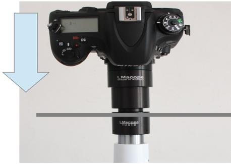
Jetzt stecken Sie einfach die gesamte Einheit (LM Digital SLR Adapter und Kamera) in den TUSTB, der bereits im Fototubus Ihres Mikroskops fixiert ist.
