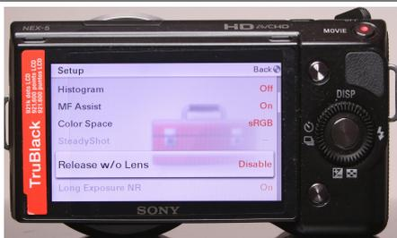
Bei einigen Kameras ist ein Auslösen nur mit montierten Objektiven möglich. Sollte dies bei Ihrer Kamera zutreffen, so stellen Sie im Menü Einstellungen den Punkt „Auslöser ohne Objektiv“ ein (Wortwahl bei jedem Hersteller etwas anders).
