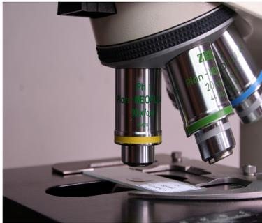
Schwenken Sie das 10-fach-Mikroskop-Objektiv ein und stellen Sie mithilfe der Mikroskop-Fokussierung das Bild visuell über den Beobachtertubus scharf. Optimal für perfekte Mikro-Fotos sind planachromatische, Plan Fluoride oder planapochromatische Mikroskopobjektive.
